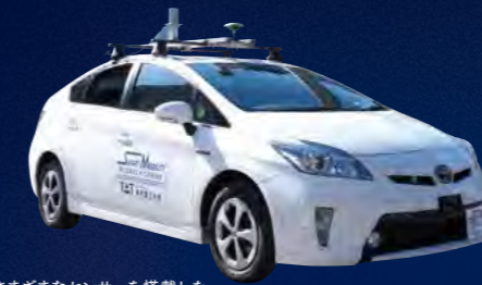
さまざまなセンサーを搭載した 運転支援開発用実験車
