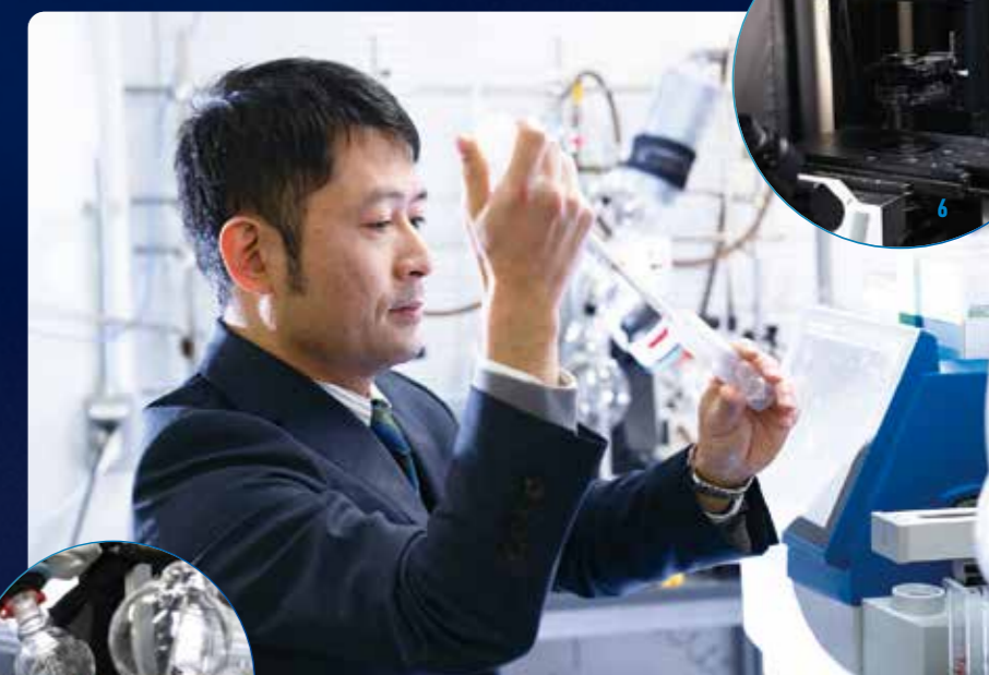
5 ローターエバポレーターという装置を使ってペプチドを作製 6 材料の観察を行う顕微鏡
