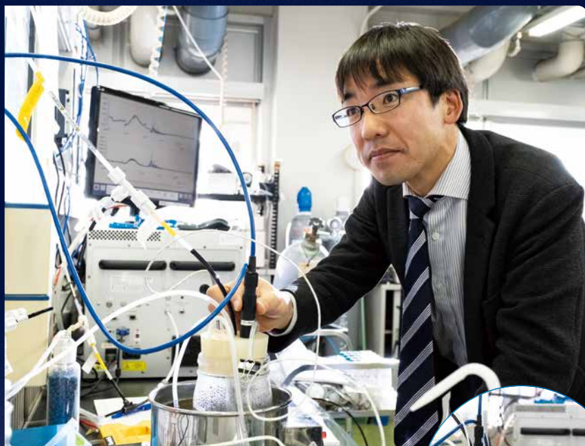
7 排水に含まれる亜酸化窒素の濃度と経路を計測する装置
