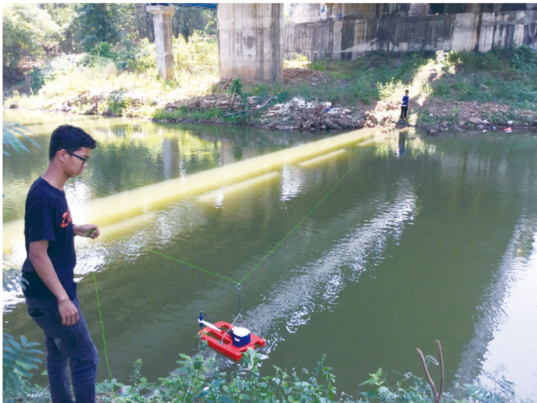
インドネシアでの ADCP による流量観測 Flow Observation by ADCP in Indonesia
