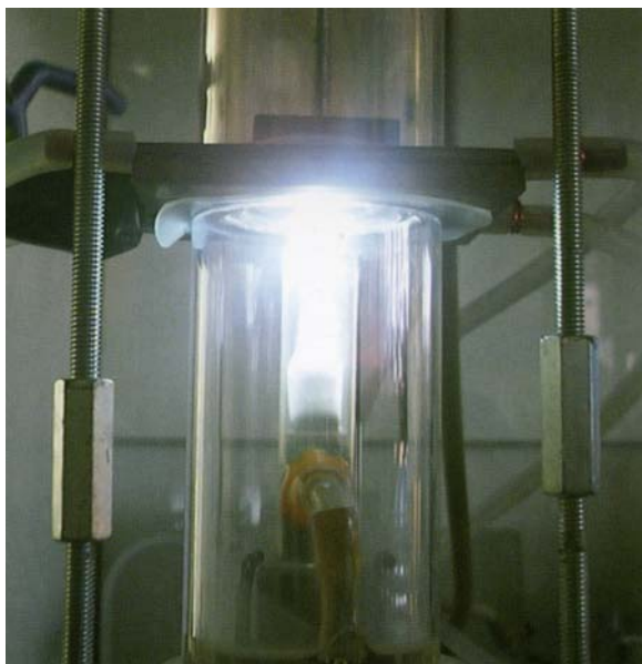
プラズマを利用したダイヤモンド合成の様子
