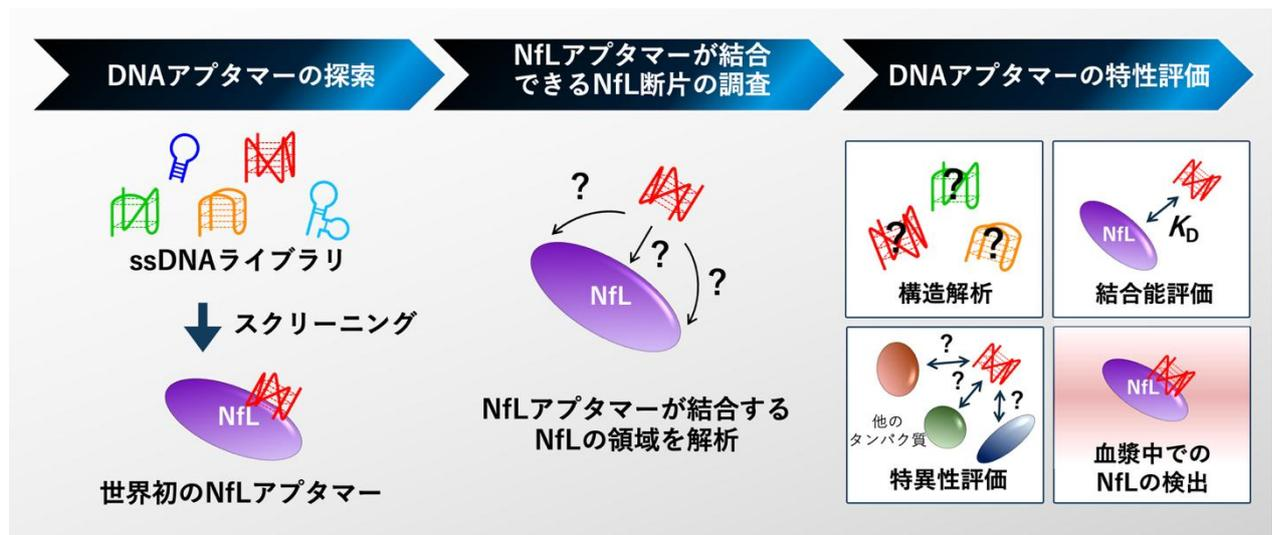
図 1. 本研究の概要。SELEX によるスクリーニングから NfL アプタマーの候補分子を選抜、NfL アプタマーが結合する NfL 領域を解析し、候補アプタマーの中から 2 種類を選別して詳細な特性評価を行った。
