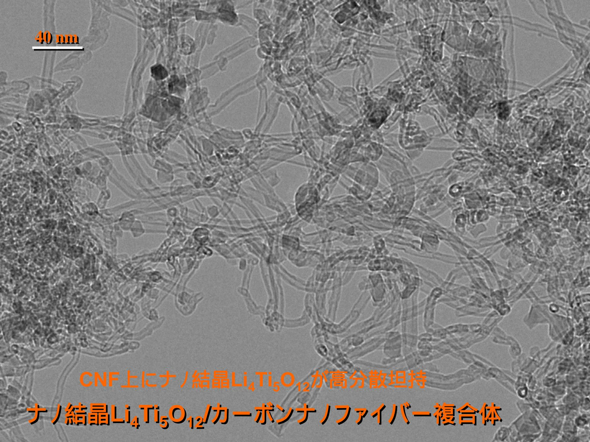
CNF上にナノ結晶 $\text{Li}_4\text{Ti}_5\text{O}_{12}$ が高分散担持
