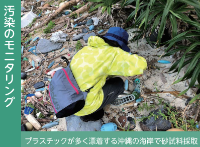
プラスチックが多く漂着する沖縄の海岸で砂試料採取
