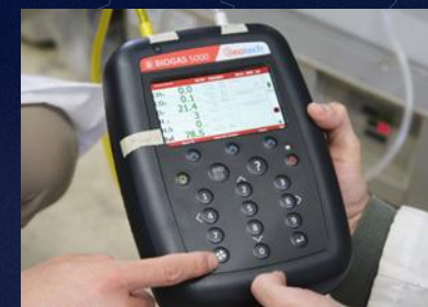
専用機器でメタンガスを測定
