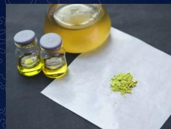
培養中の藻類(奥)から抽出したオイル(左)と精製した乾燥バイオマス(右)
