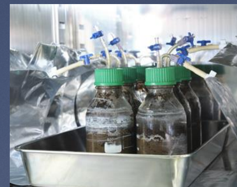
バイオリアクターに接続したガスバッグにメタンガスが溜まっていく
