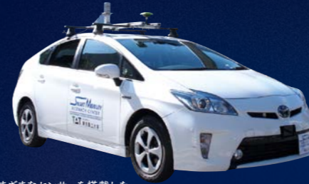
さまざまなセンサーを搭載した 運転支援開発用実験車
