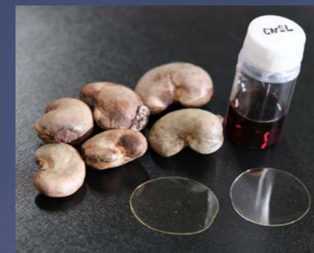
殻付きカシューナッツ(左)、精製した植物油(右上)、合成したバイオマスプラスチック(右下)
