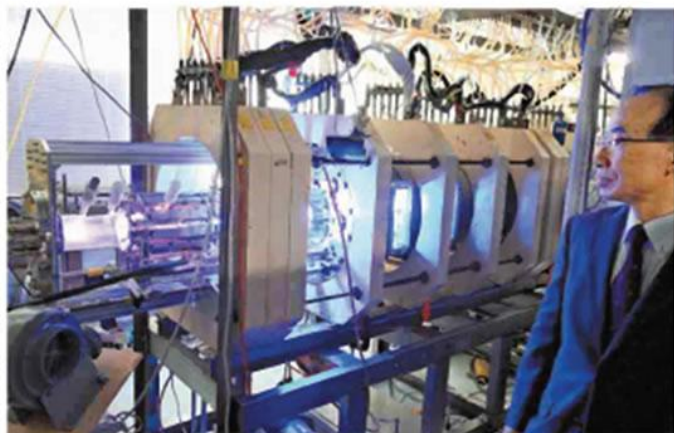
東京農工大のヘリコンプラズマを生成する実験装置
