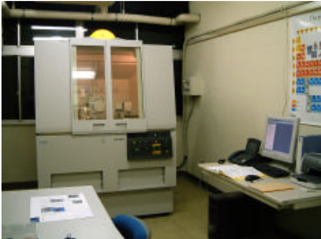
図 1 薄膜材料結晶性解析 X 線回折装置（スペクトリス株式会社：X'Pert-MRD）設置状況
