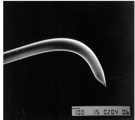
図 8 ベントタイプのファイバ・プローブ
