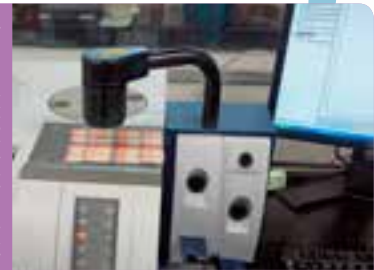
布地の材質を近赤外光で調べる。製品の管理から、使用済衣類のリサイクル、リユースまで、布地の材質分析は重要。光を使って非破壊で迅速に材質や成分比を測定する手法の開発を行っている。
