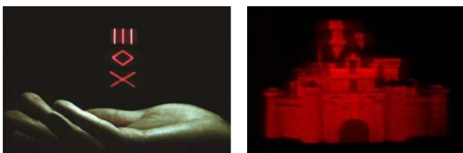
図 25 水平視差型ホログラフィーの再生像の例：水平視域角 15°、画面サイズ 4.1 インチのホログラム表示を実現。
