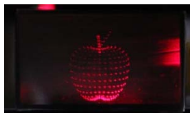
図 26 ホログラム表示モジュール：解像度変換技術を用いて、画面サイズ 2.0 インチで視域角 11° のホログラム表示を実現。必要な光学系が小型モジュール内にすべて収まっている。
