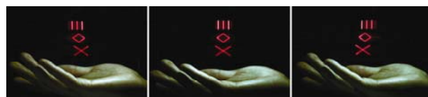
図 23 水平視差型ホログラフィーの再生像の例:DMD と水平走査光学系で画素ピッチ 2.5 \mu\text{m} のホログラム表示を実現。
