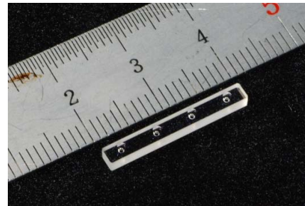
Micro lens array N.A. 0.11 \Rightarrow 0.30
