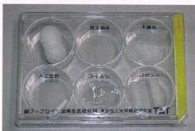
(上) 絹繊維を溶媒に溶かして様々な方法・構造で再固化させると、絹の特質を活かした多彩な有用物質が作れる。人体との馴染みがよいことから人工臓器用の足場材としての期待が大きい。(左) 絹フィブロインから作られる素材のサンプル。
