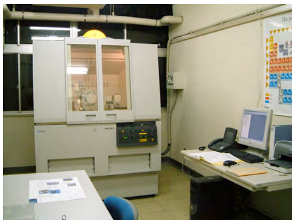
図 1 薄膜材料結晶性解析 X 線回折装置設置状況
