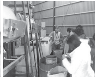
きのこ培地（廃菌床）を再利用するボイラー（さくらファーム） Boiler reusing mushroom bed wastes (Sakura Farm)
