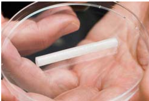
直径3ミリの絹製の人工血管(写真左)。触ると弾力がある。乾燥による損傷を防ぐため、水に入れて保管されている(写真右)
